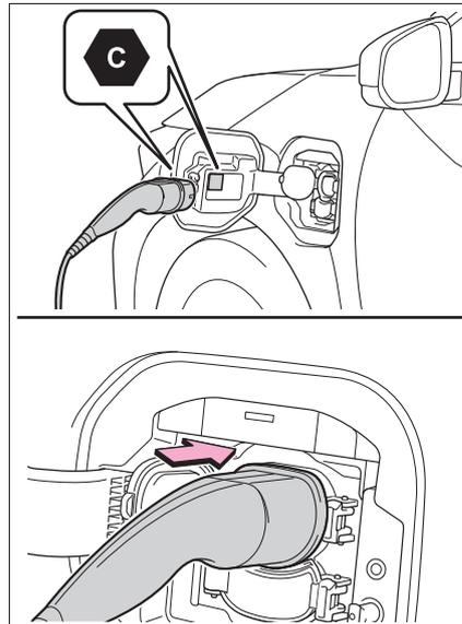
**6** Überprüfen Sie, ob die Ladekontrollleuchte des Ladeanschlusses leuchtet.
